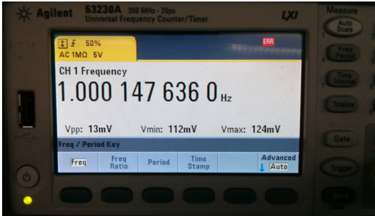
图 2. 未修正晶振误差时的输出
