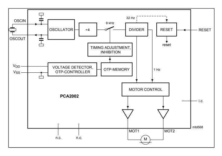
Block diagram: PCA2002CX8, PCA2002U, PCA2003U Block Diagram
