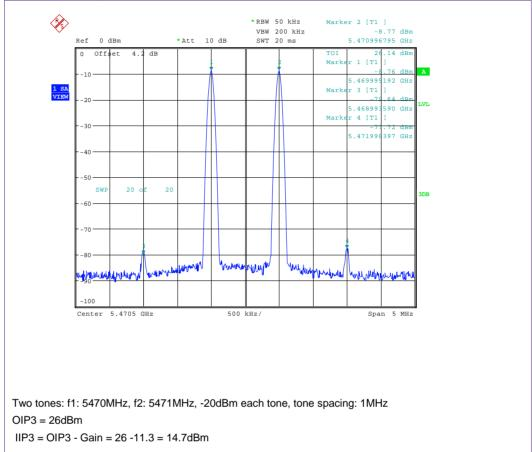
Fig 9. BFU730LX 5-5.9GHz WiFi LNA: IP3
