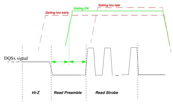
Figure 6. DQS Read Gating Calibration: Timing Diagram
