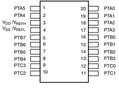
Figure 22. 20-pin SOIC package
