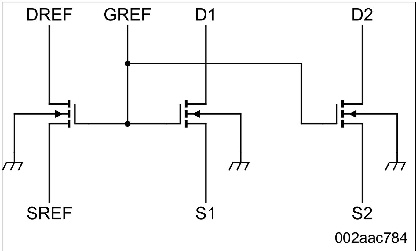
**Block diagram: GTL2002D, GTL2002DC, GTL2002DP, GTL2002GM Block Diagram**
