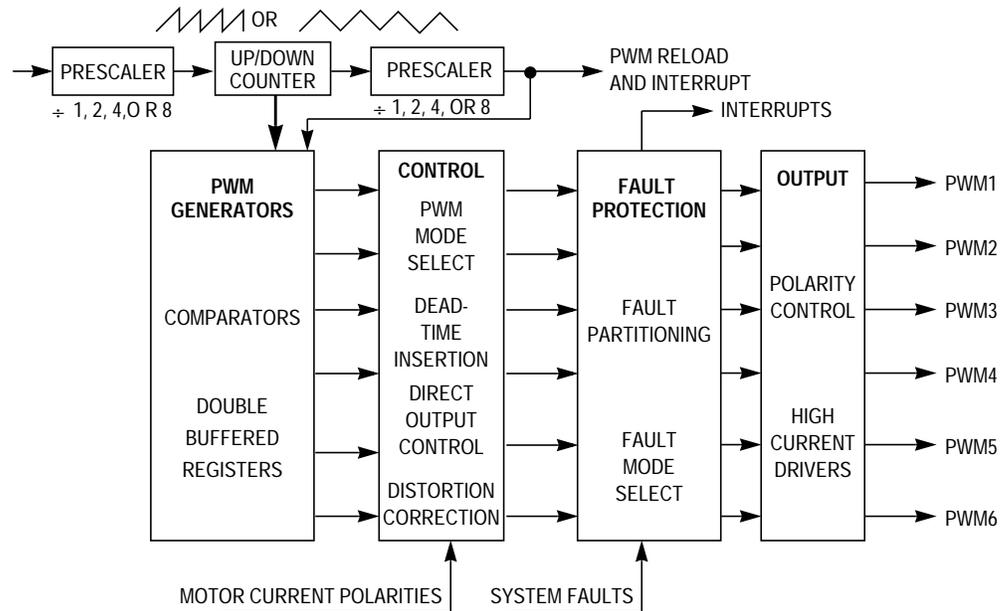
**Figure 2. PWMMC Module Block Diagram**
