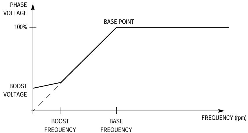
**Figure 23. Volts-per-Hertz Ramp**
