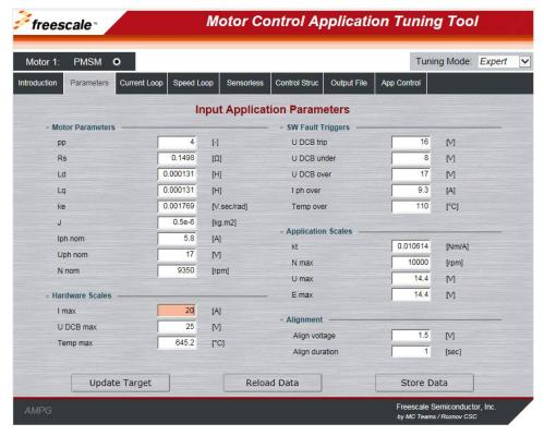
Figure 28. MCAT input application parameters page
