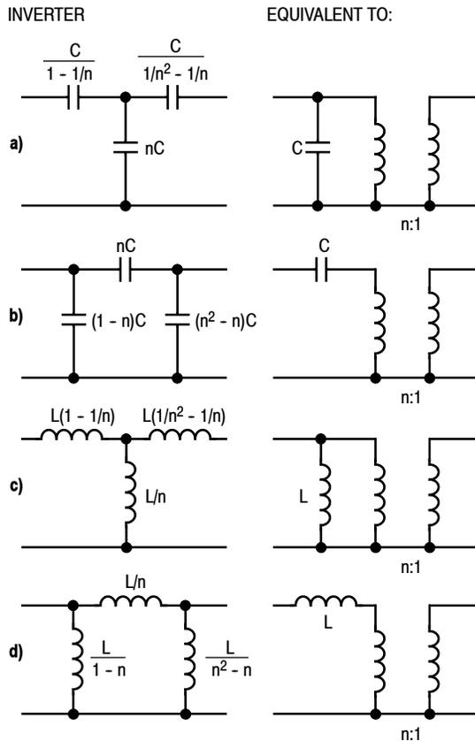
**Figure 26. Impedance Inverters**
