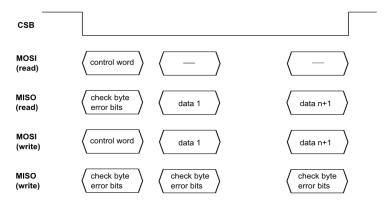
Figure 32. SPI protocol mode B
