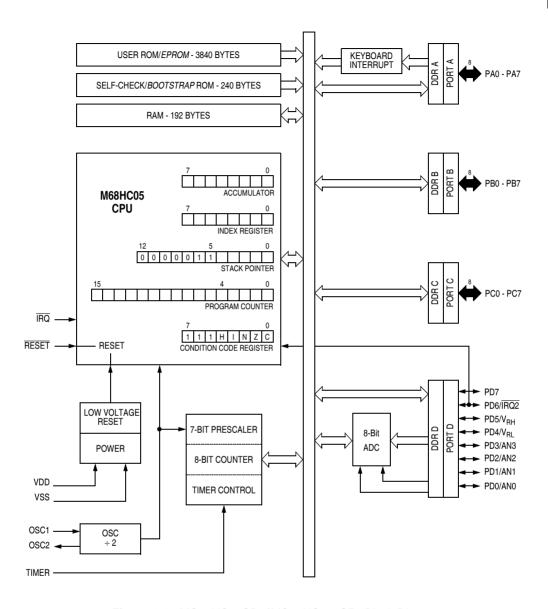
Figure 1-1 MC68HC05SR3/MC68HC705SR3 Block Diagram
