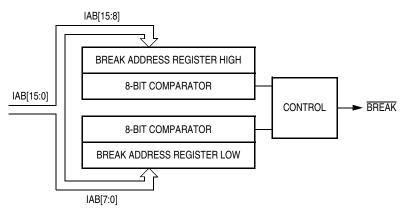
Figure 18-2. Break Module Block Diagram
