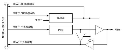
Figure 12-8. Port B I/O Circuit
