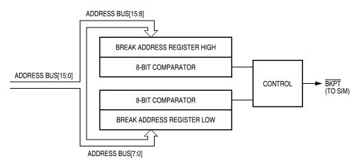
Figure 18-2. Break Module Block Diagram
