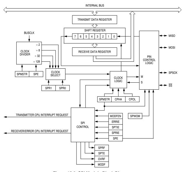
Figure 15-2. SPI Module Block Diagram
