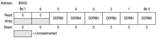
Figure 12-7. Data Direction Register B (DDRB)
