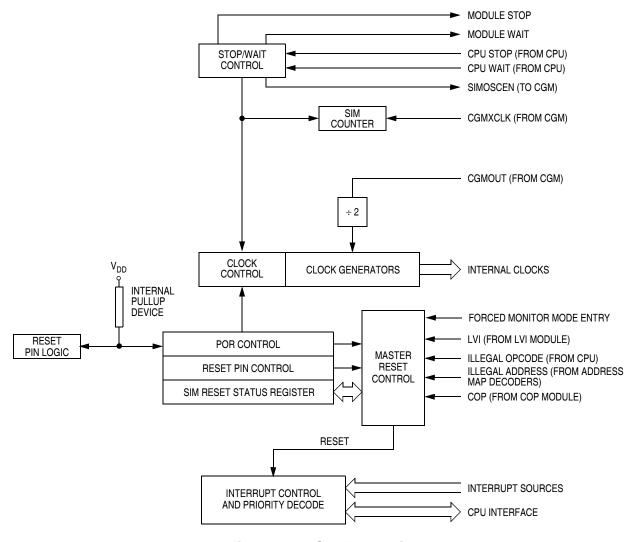
Figure 14-1. SIM Block Diagram
