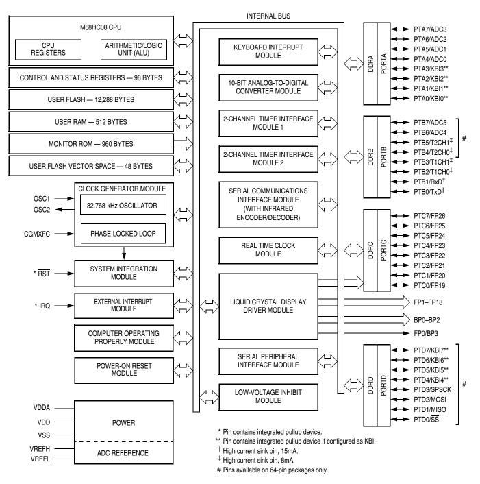
Figure 1-1. MC68HC908LJ12 Block Diagram
