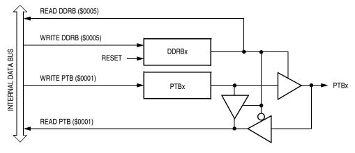
Figure 17-7. Port B I/O Circuit
