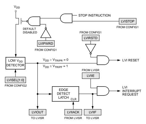
Figure 21-2. LVI Module Block Diagram
