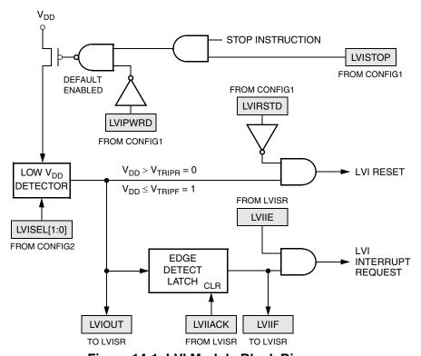
Figure 14-1. LVI Module Block Diagram
