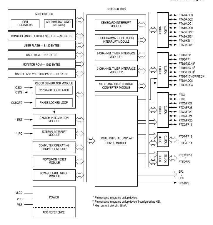
Figure 1-1. MC68HC908LV8 Block Diagram
