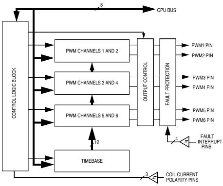
Figure 12-2. PWM Module Block Diagram
