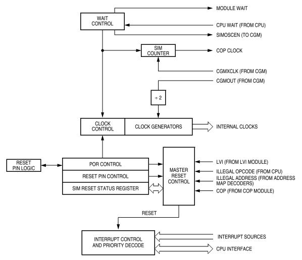
Figure 14-1. SIM Block Diagram
