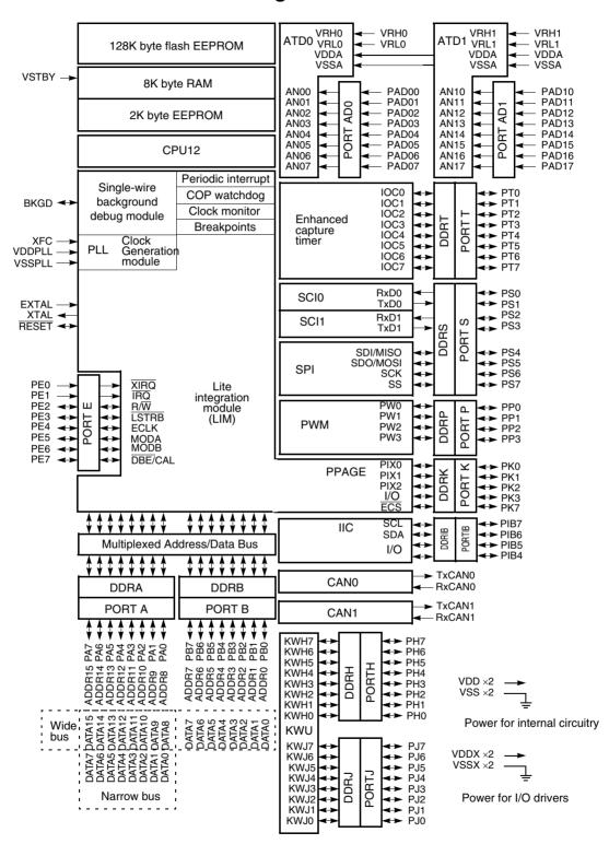
Figure 1-2. MC68HC912DG128A Block Diagram
