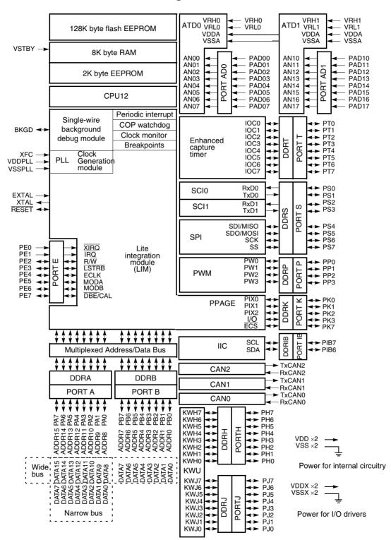
Figure 1-1. MC68HC912DT128A Block Diagram
