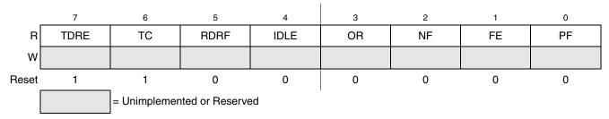
Figure 11-8. SCI Status Register 1 (SCIxS1)
