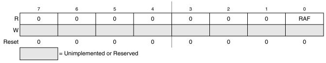
Figure 11-9. SCI Status Register 2 (SCIxS2)
