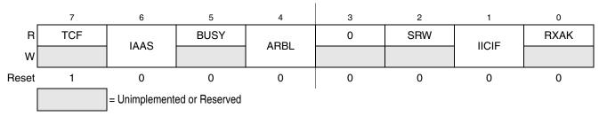
Figure 13-6. IIC Status Register (IIC1S)
