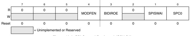
Figure 12-6. SPI Control Register 2 (SPI1C2)
