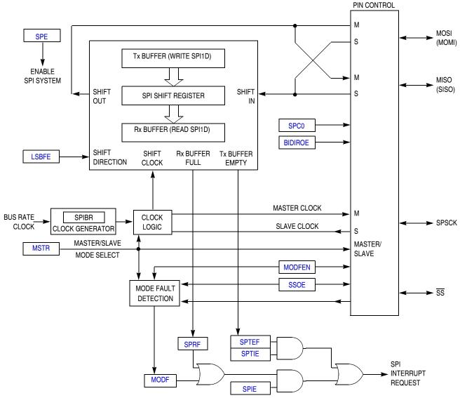
Figure 12-3. SPI Module Block Diagram
