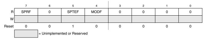
Figure 12-8. SPI Status Register (SPI1S)
