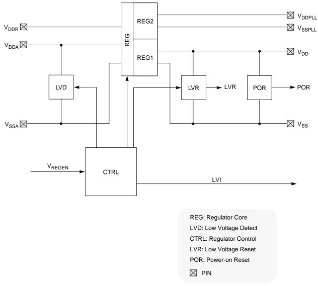
Figure 14-1. VREG3V3 Block Diagram
