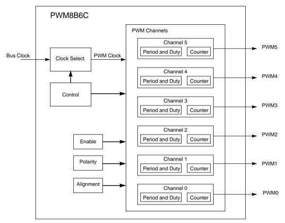
Figure 12-1. PWM8B6CV1 Block Diagram
