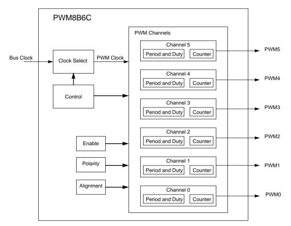
Figure 12-1. PWM8B6CV1 Block Diagram
