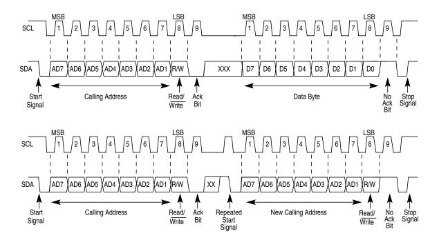
Figure 10-9. IIC-Bus Transmission Signals
