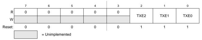
Figure 9-10. MSCAN Transmitter Flag Register (CANTFLG)
