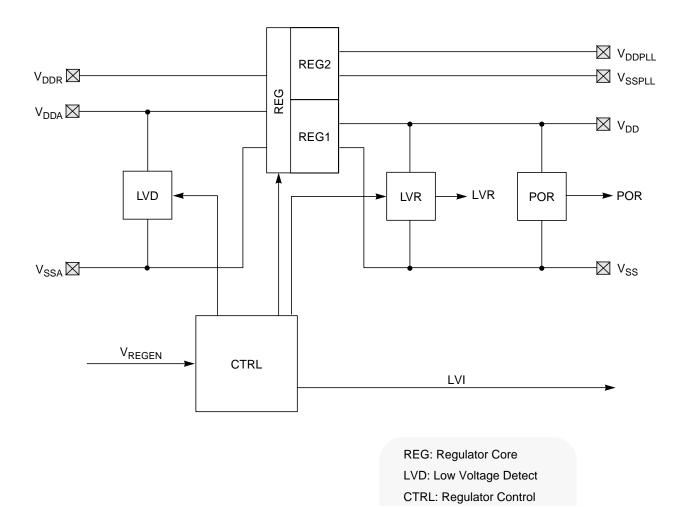
Figure 14-1. VREG3V3 Block Diagram
