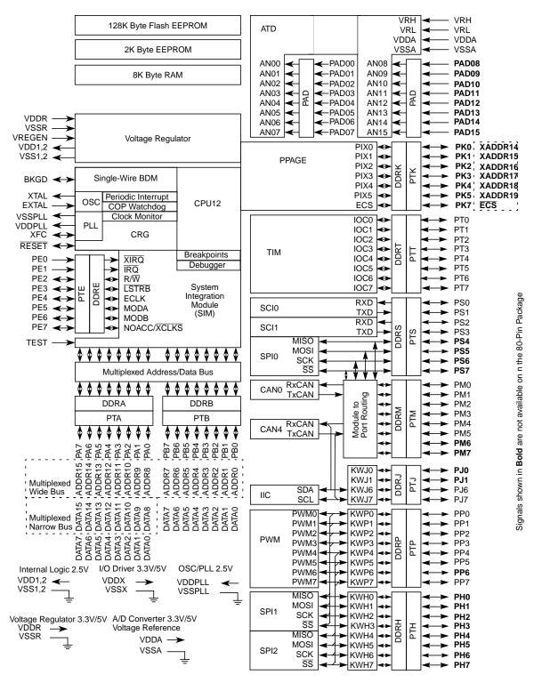
Figure 1-2. MC9S12KG128 Block Diagram
