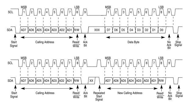
Figure 8-9. IIC-Bus Transmission Signals
