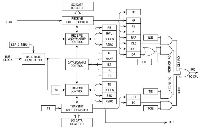
Figure 10-9. SCI Block Diagram
