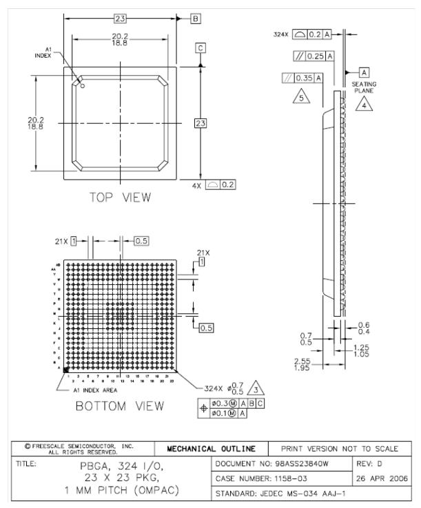
Figure 29. MPC5565 324 TEPBGA Package
