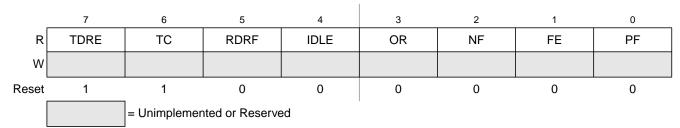
Figure 14-9. SCI Status Register 1 (SCIxS1)
