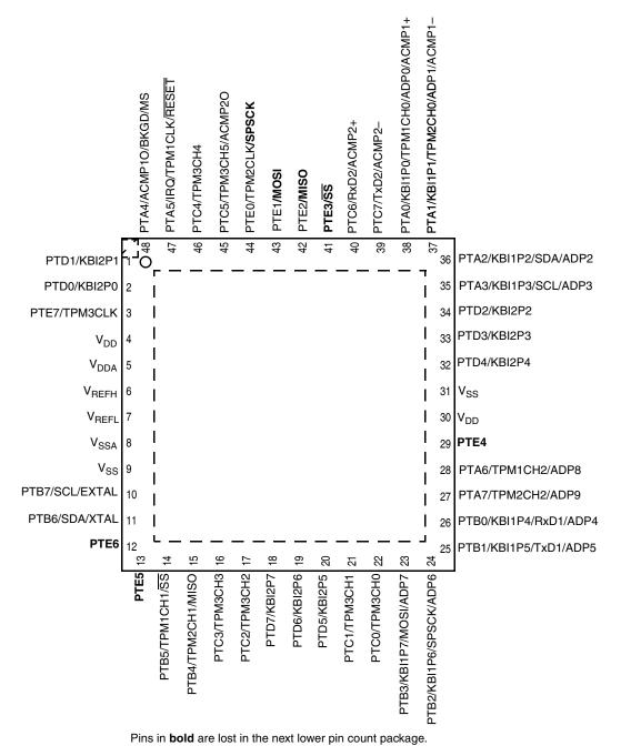
Figure 2-1. 48-Pin QFN
