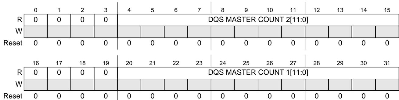
**Figure 13-17. DQS Delay Status (DQS\_DELAY\_STATUS) Register**
