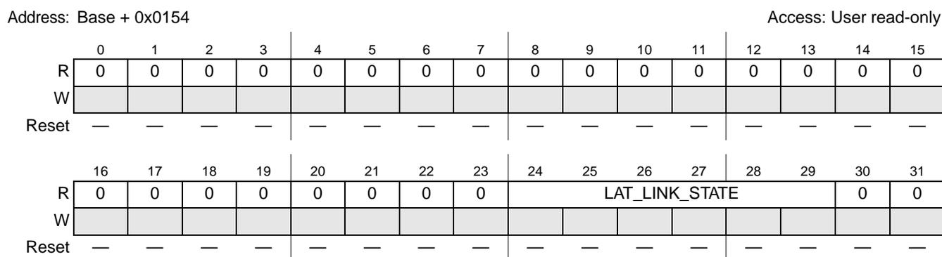
**Figure 33-9. Link Layer Status Register 0 (LINK\_STATUS0)**
