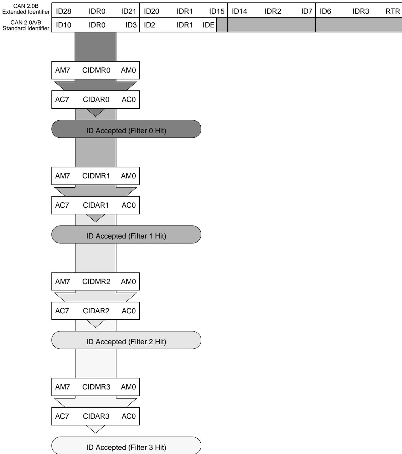
**Figure 25-36. 8-Bit Maskable Identifier Acceptance Filters**
