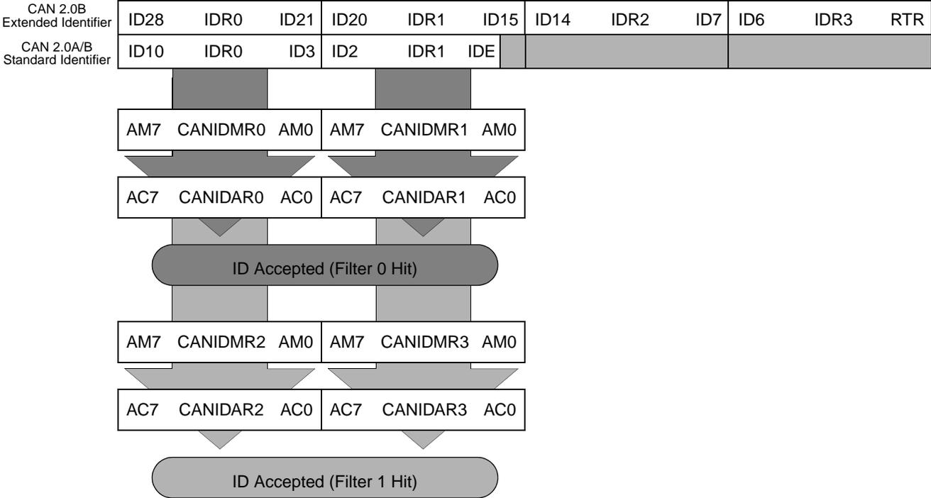
**Figure 25-35. 16-Bit Maskable Identifier Acceptance Filters**
