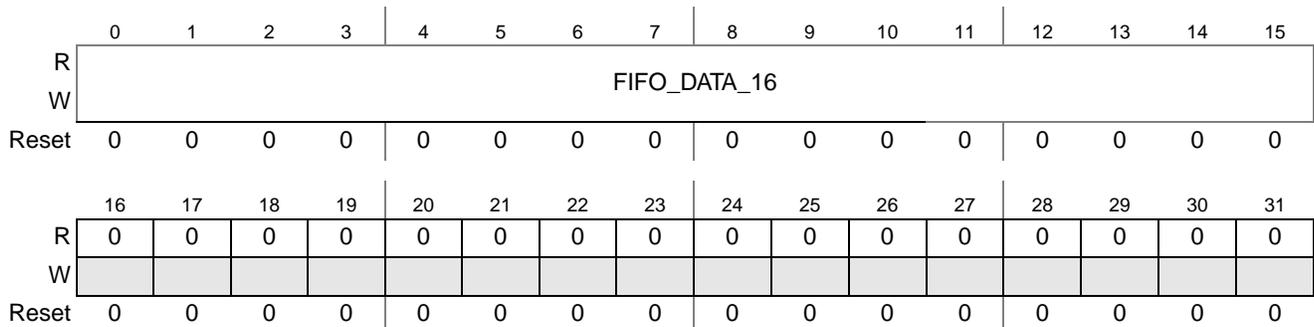
**Figure 27-9. FIFO Data 16 Register**
