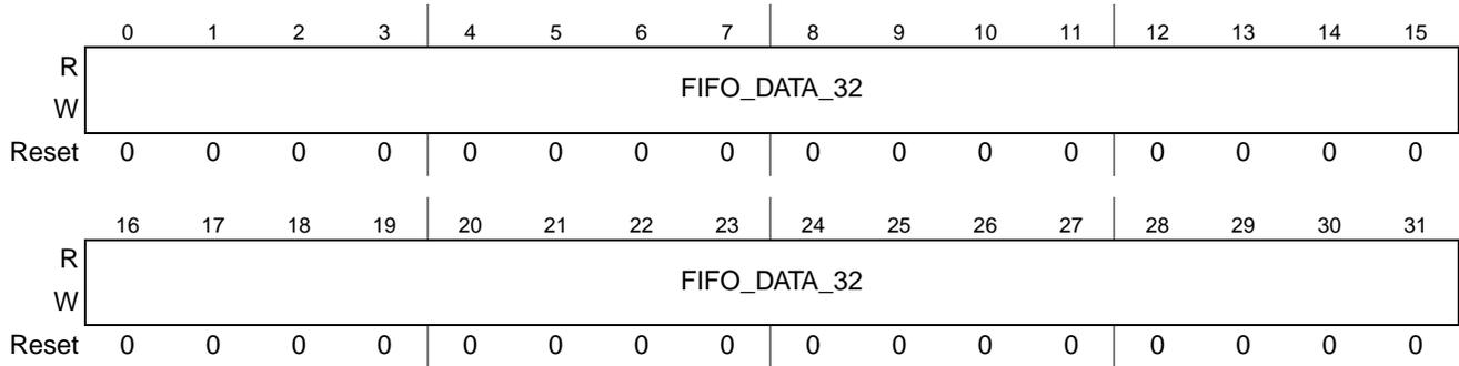
**Figure 27-8. FIFO Data 32 Register**
