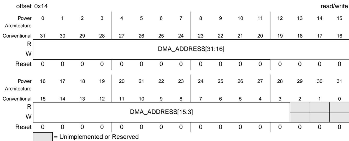
**Figure 40-7. DMA\_ADDRESS Register**
