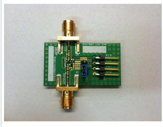
Fig 1. BGU7003 2.4GHz LNA evaluation board.
