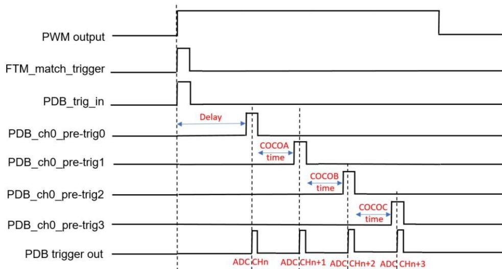
图 3. PDB 的触发、预触发输出信号触发 ADC 转换的时序图
