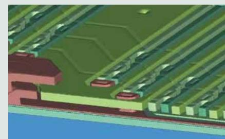
下一代高深宽比微机电系统(HARMEMS)技术具有25um厚度的可移动元件，
