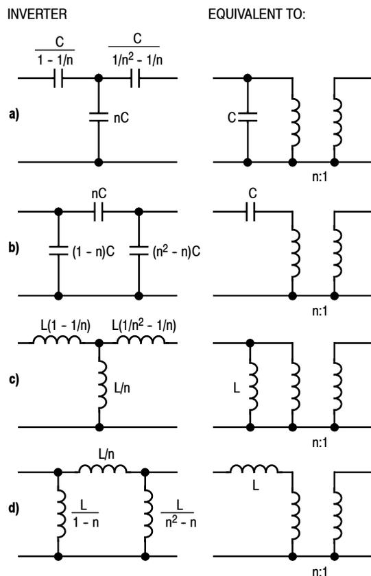
**Figure 26. Impedance Inverters**
