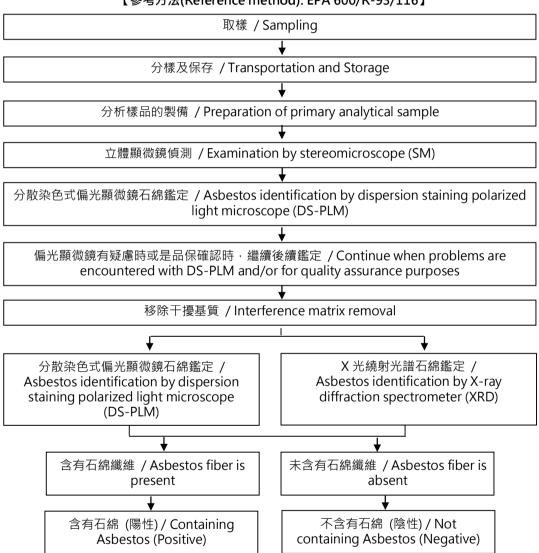
石綿鑑定分析流程圖 / Analysis flow chart for determination of Asbestos
