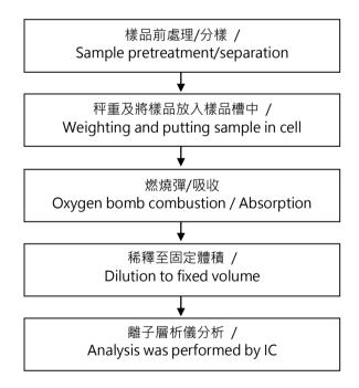
鹵素分析流程圖 / Analytical flow chart - Halogen
