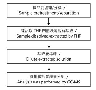
【測試方法/Test method: IEC 62321-8】
