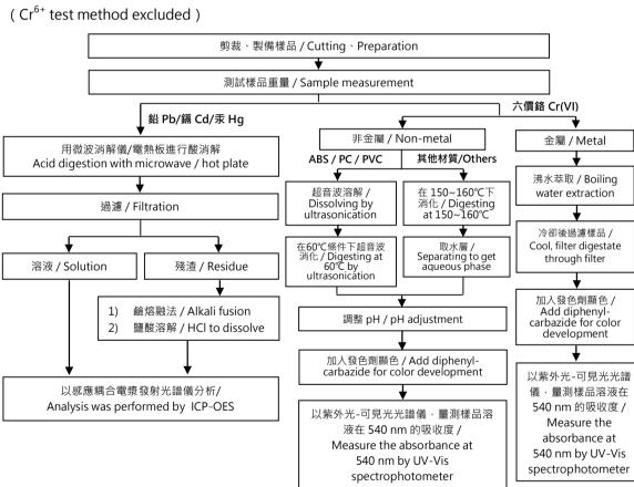
重金屬流程圖 / Analytical flow chart of heavy metal
