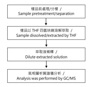
【測試方法/Test method: IEC 62321-8】
