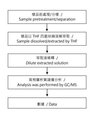
【測試方法/Test method: IEC 62321-8】
